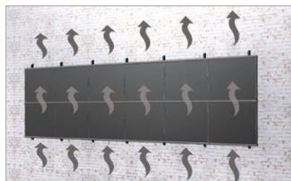
Buena ventilación trasera de los módulos
